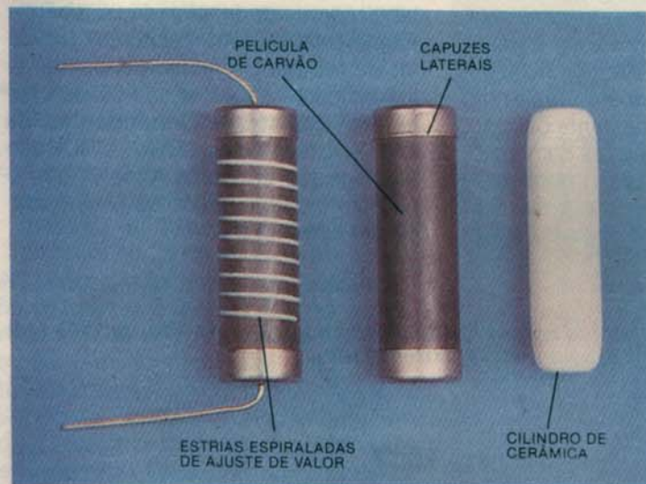
ACIMA: fases de fabricação de um resistor de película de carvão.
