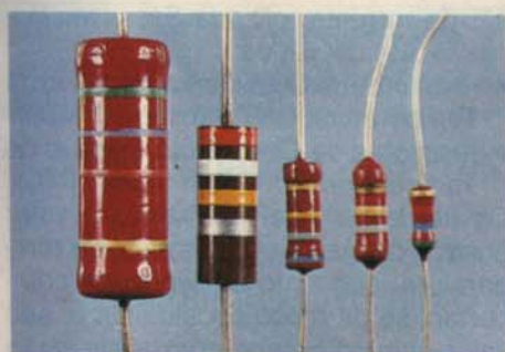
ACIMA: são os diferentes tamanhos dos resistores pirolíticos que determinam a capacidade de dispersar o calor.
