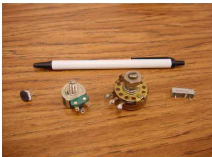
Figura 1.2: Resistores variáveis - potenciômetros .
