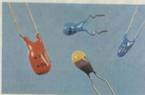
ACIMA: capacitores de tântalo do tipo "gota".
